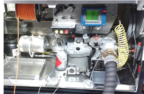
Armaturenschrank auf einem Straßentankwagen
