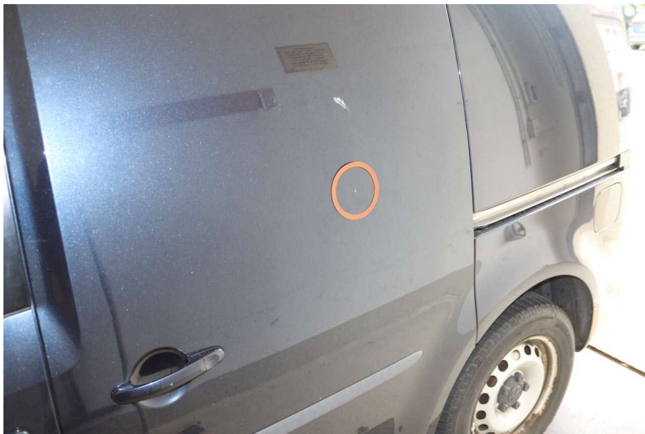
Bild 13 zeigt die Parkdelle an der linken Schiebetür
