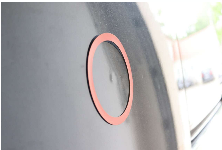
Bild 14 zeigt die Parkdelle an der linken Schiebetür im Detail
